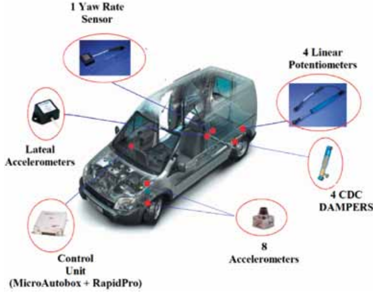
Şekil 16. MEKAR araç dinamiği çalışmasındaki bileşenler
