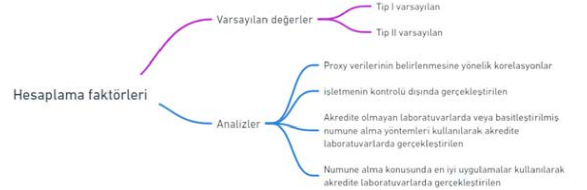
Şekil 6.9. Hesaplama faktörlerinin belirlenmesine ilişkin yöntemler
