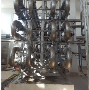
TMO Afyon Alkaloidleri harici MBR, NF ve evaporasyon-kristalizasyon üniteleri
